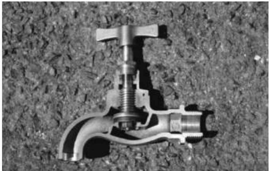
Figuur 5.3.2: 'n Dwarsprofiel van 'n kraan
