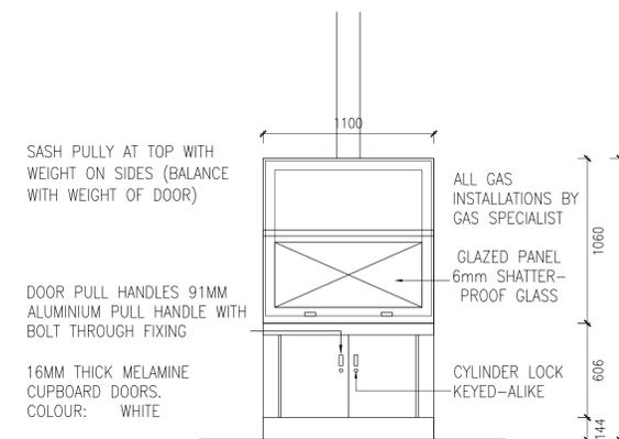
SASH PULLY AT TOP WITH WEIGHT ON SIDES (BALANCE WITH WEIGHT OF DOOR)
